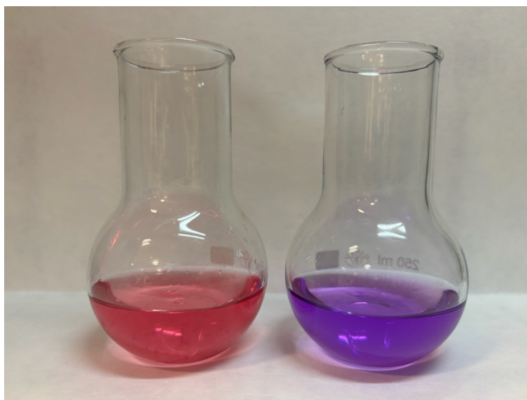
Obrázek 2 Zbarvení roztoku s indikátorem Murexid před bodem (vlevo) a v bodu (vpravo) ekvivalence.
