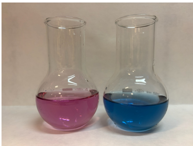
Obrázek 1 Zbarvení roztoku s indikátorem Eriochromová čern T před bodem (vlevo) a v bodu (vpravo) ekvivalence.
